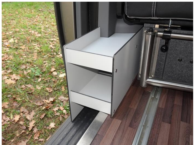
Abb. 1-6 Schiebetürregal 13229 in VW T6 Caravelle
