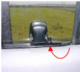
Setzen Sie den Riegel in das Arretierungsloch und drehen Sie ihn so, daß die Fensterverriegelung in die Bohrung einrastet. Alternativ kann auch ein weiteres Verriegelungsloch in den Fensterrahmen gebohrt werden.
