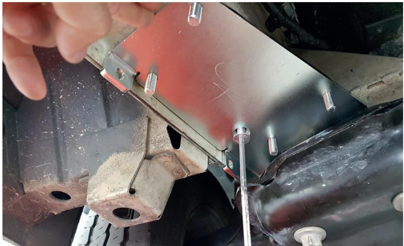
Fije el adaptador con la placa de montaje que ha introducido en el orificio.
