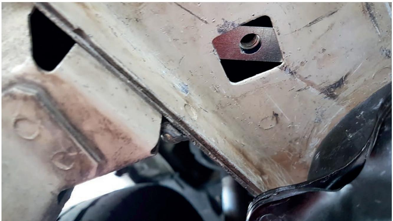
Inserire la piastra di montaggio con il foro della vite concentrico al foro quadrato del telaio.
