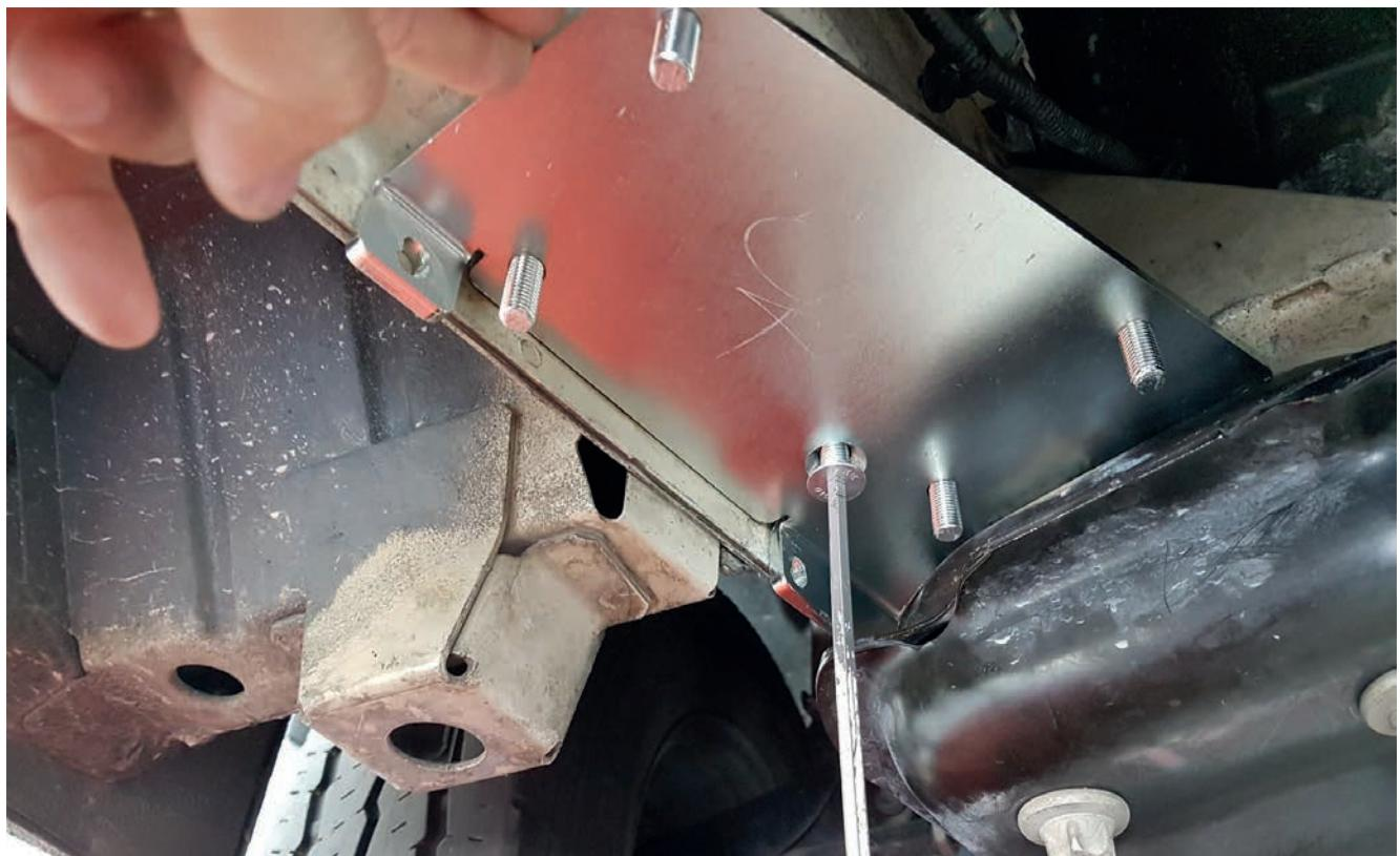
Befestigen Sie den Adapter mit der Montageplatte, die Sie in die Bohrung eingesetzt haben.
