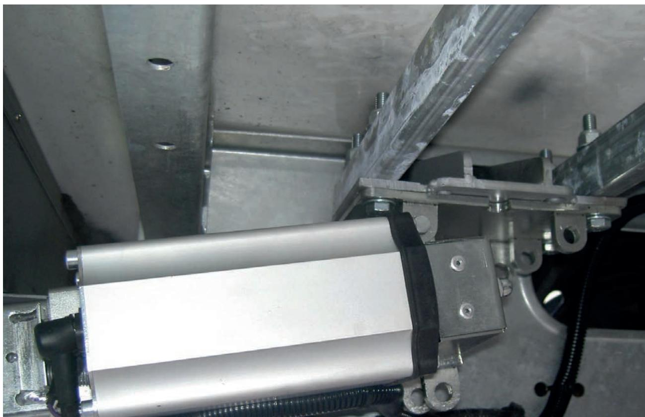
Montieren Sie die Wagenheber in der für Sie bequemsten Position. Der Adapter wurde entwickelt, um die Wagenheber in verschiedenen Einstellungen zu montieren.
