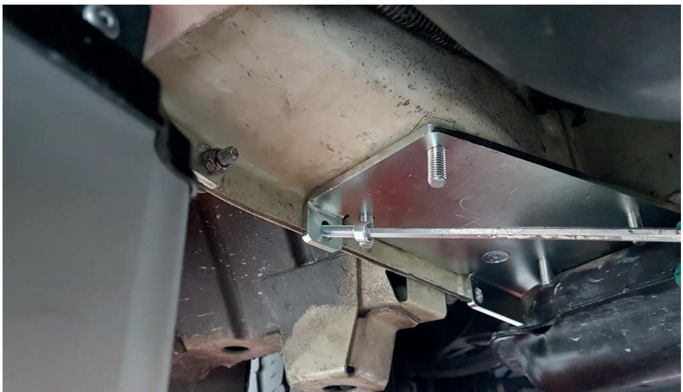
Fixez la plaque de l'adaptateur avec deux boulons M8 sur le châssis.
