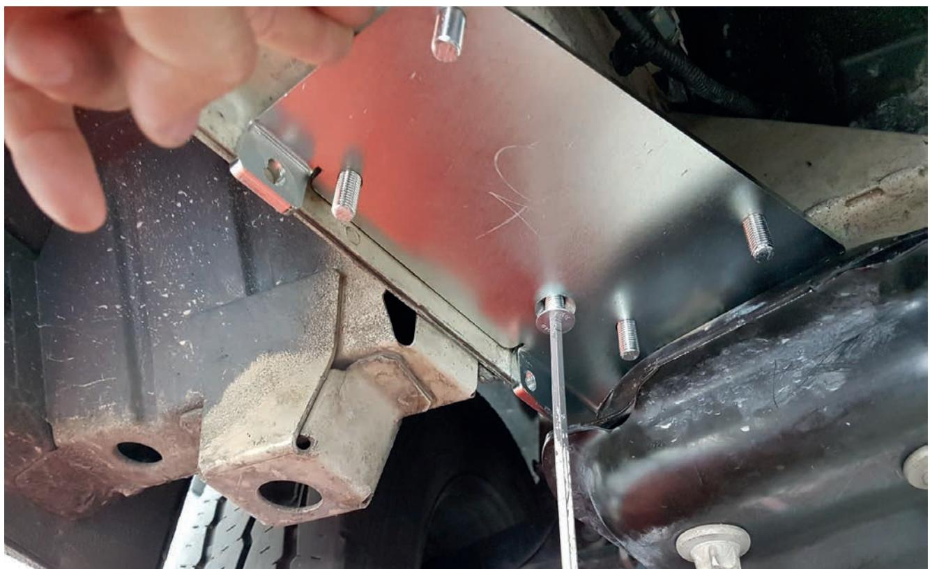
Fastgør adapteren med den monteringsplade, som du har sat i hullet.
