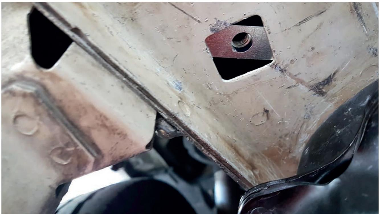
Insérez la plaque de montage avec le trou de vis concentrique au trou carré du châssis.
