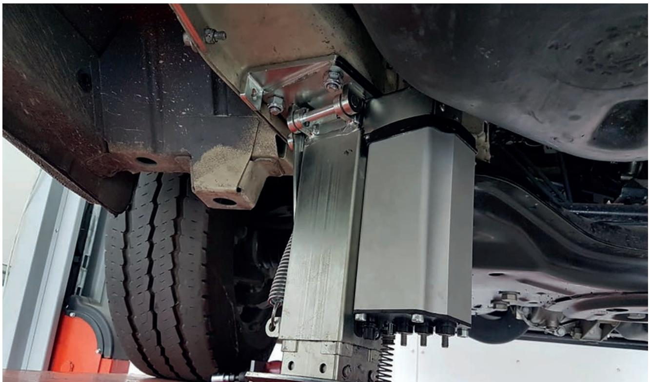
Si nécessaire, desserrez les boulons qui soutiennent le réservoir et déplacez-le de quelques centimètres vers le centre du véhicule.
