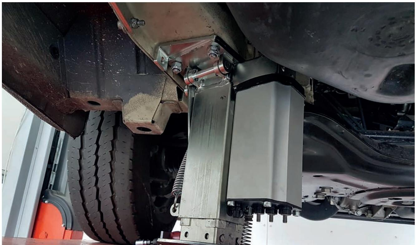
Draai zo nodig de bouten die de tank ondersteunen los en verplaats hem een paar centimeter naar het midden van het voertuig.
