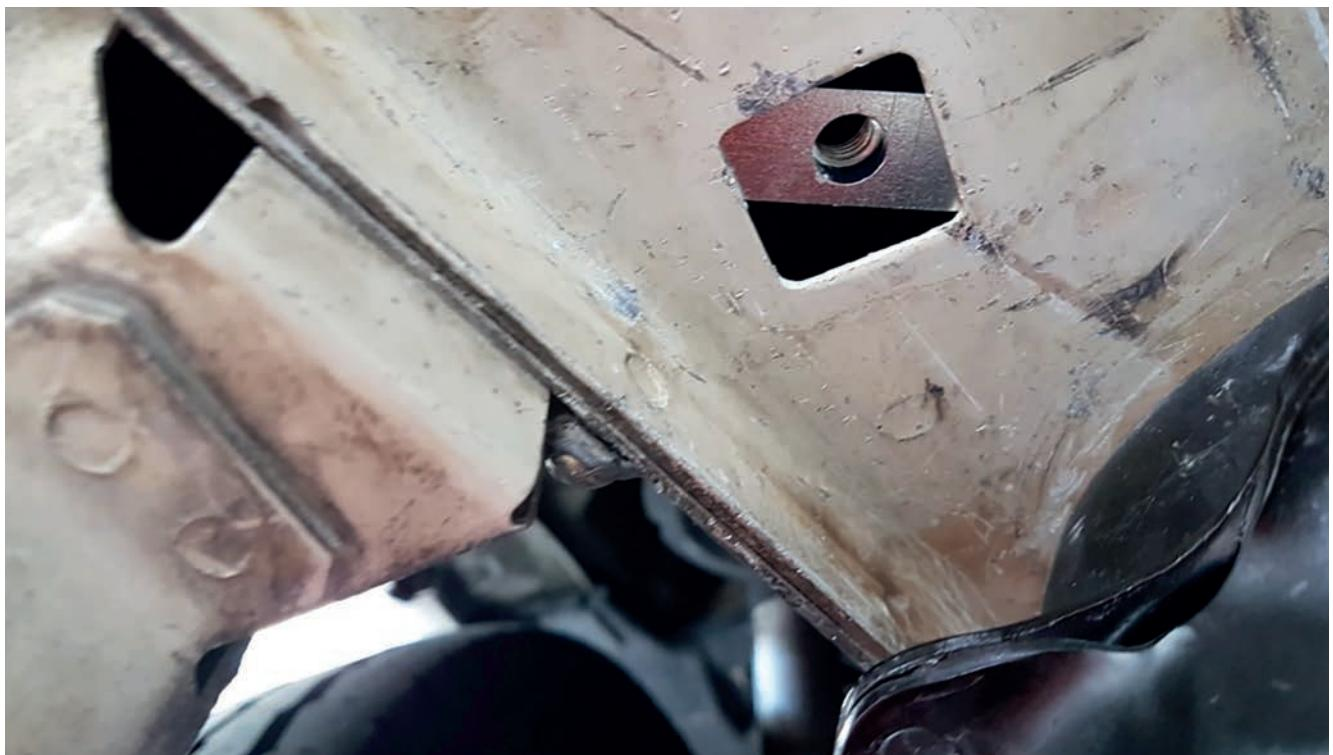
Inserte la placa de montaje con el orificio del tornillo concéntrico al orificio cuadrado del chasis.
