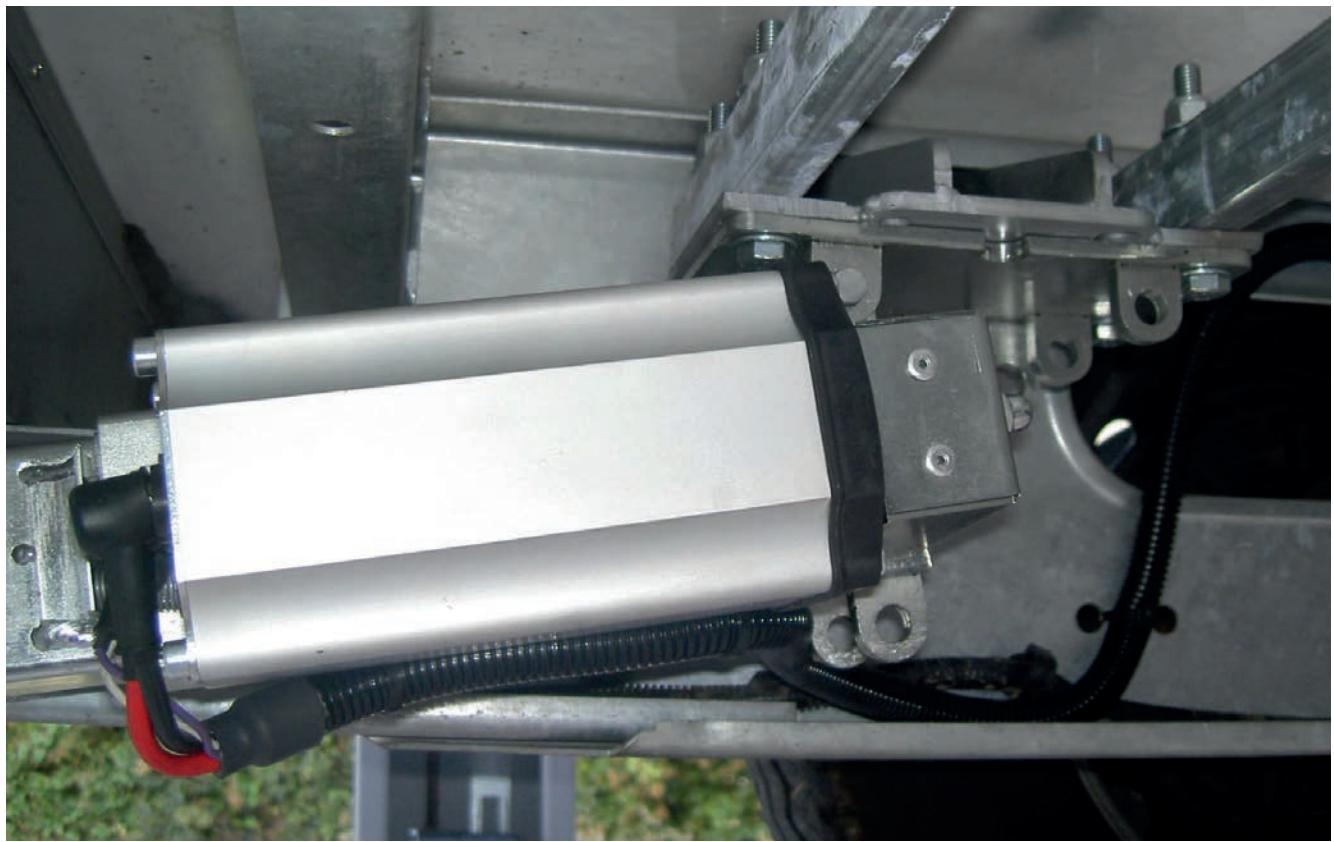
Montera domkrafterna i det mest bekväma läget för resan, adapttern är utvecklad för att passa domkrafterna i olika inställningar.
