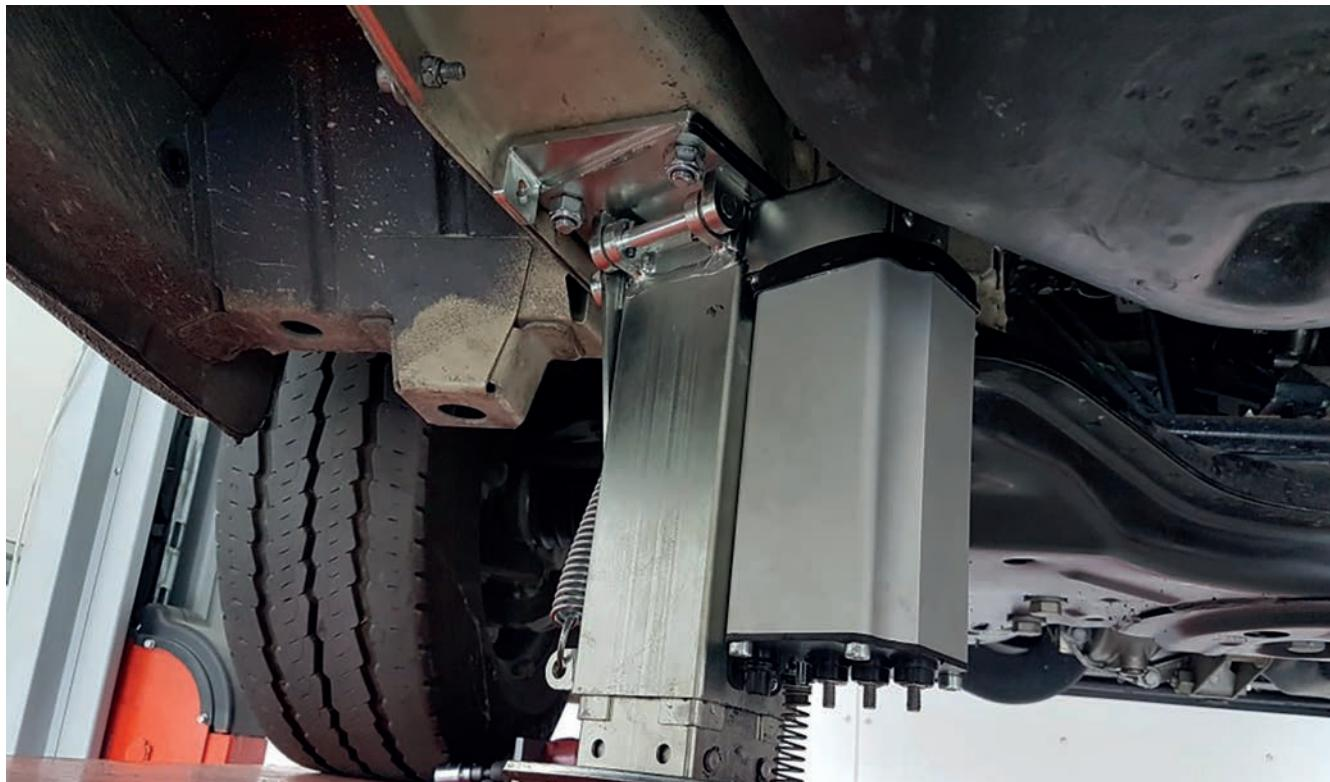
Om det behövs, lossa skruvarna som stödjer tanken och flytta den några centimeter mot fordonets mitt.
