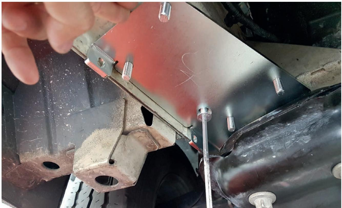
Zet de adapter vast met de montageplaat die u in het gat hebt gestoken.
