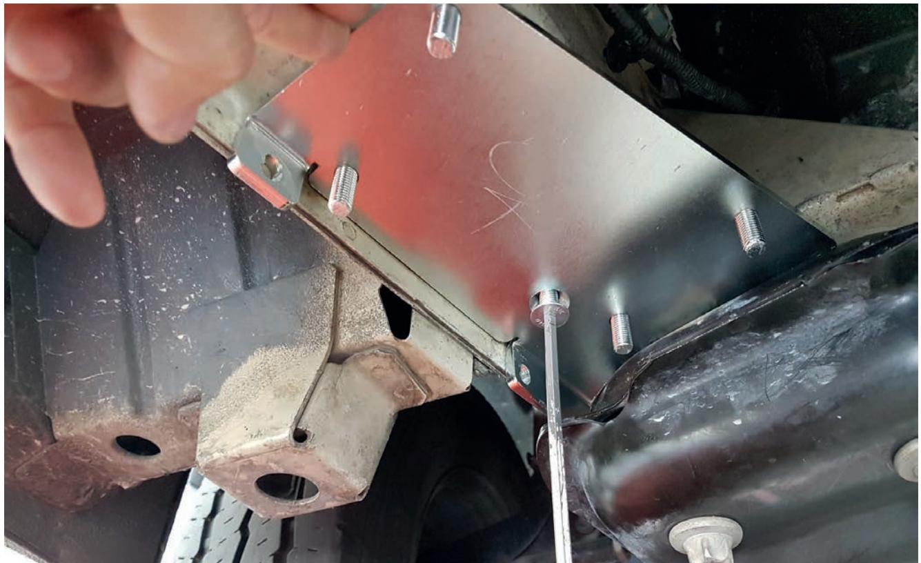
Fäst adaptern med monteringsplattan som du satte in i hålet.
