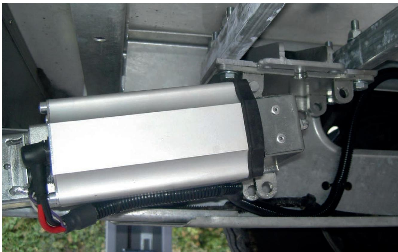
Montez les crics dans la position la plus confortable pour le déplacement, l'adaptateur est développé pour monter les crics dans différentes positions.
