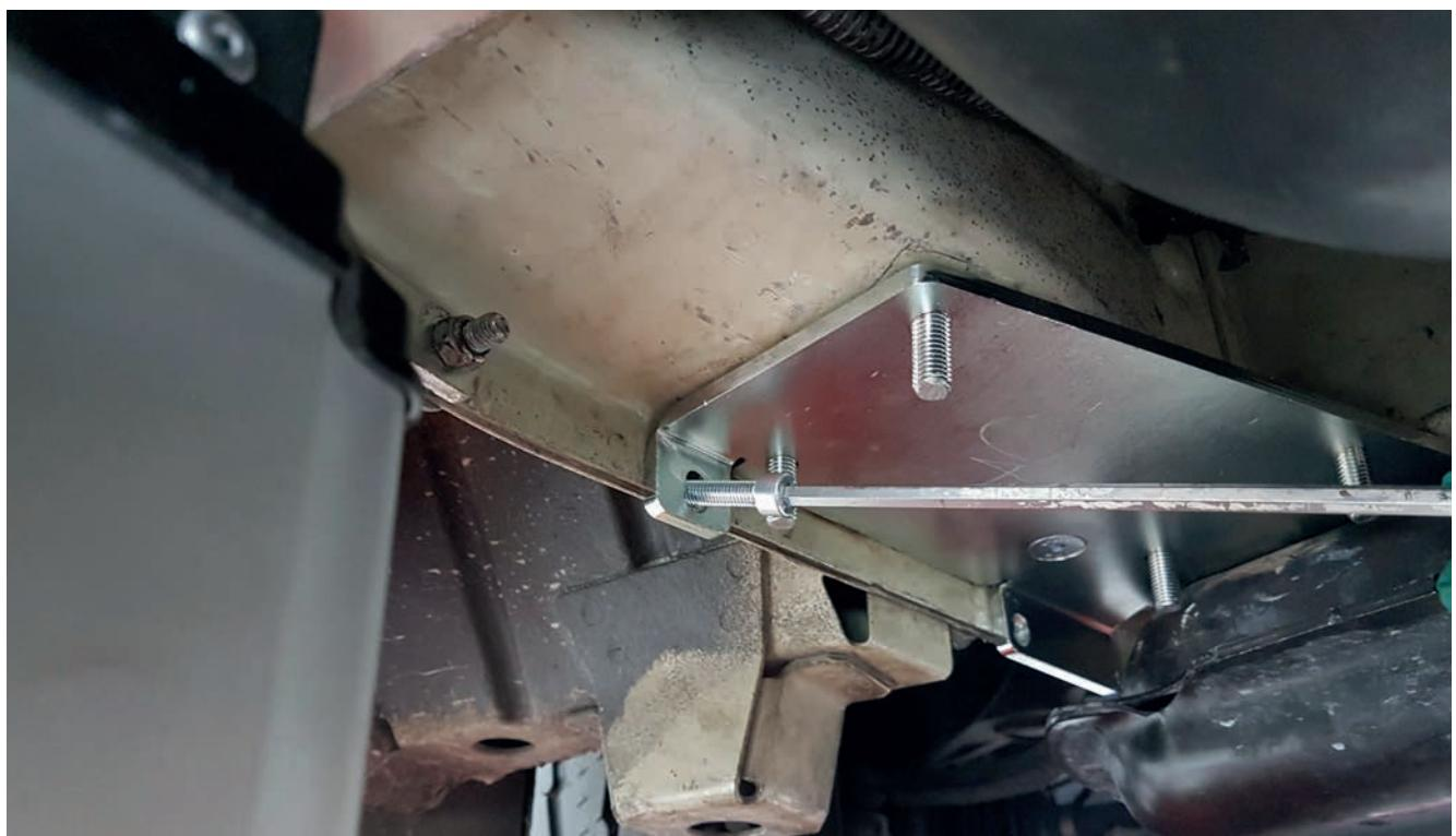
Fissare la piastra di adattamento con due bulloni M8 sul telaio.
