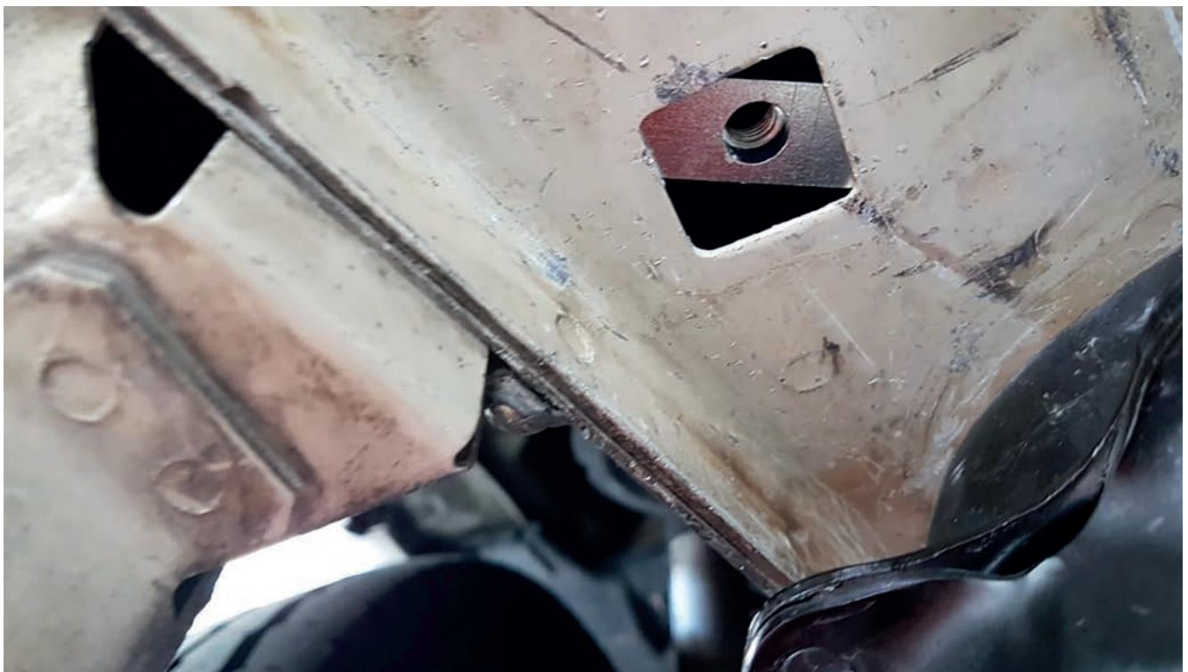
Setzen Sie die Montageplatte so ein, dass das Gewinde konzentrisch zum Vierkantloch sitzt.
