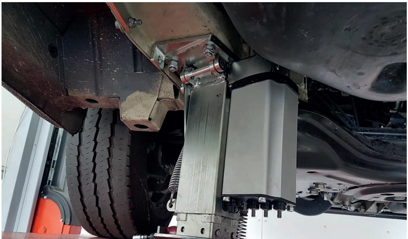
Hvis det er nødvendigt, skal du løsne boltene, der støtter tanken, og flytte den et par centimeter mod midten af køretøjet.
