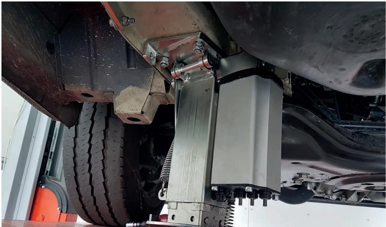
Falls erforderlich, lösen Sie die Schrauben, die den Tank halten, und verschieben Sie ihn einige Zentimeter in Richtung Fahrzeugmitte.
